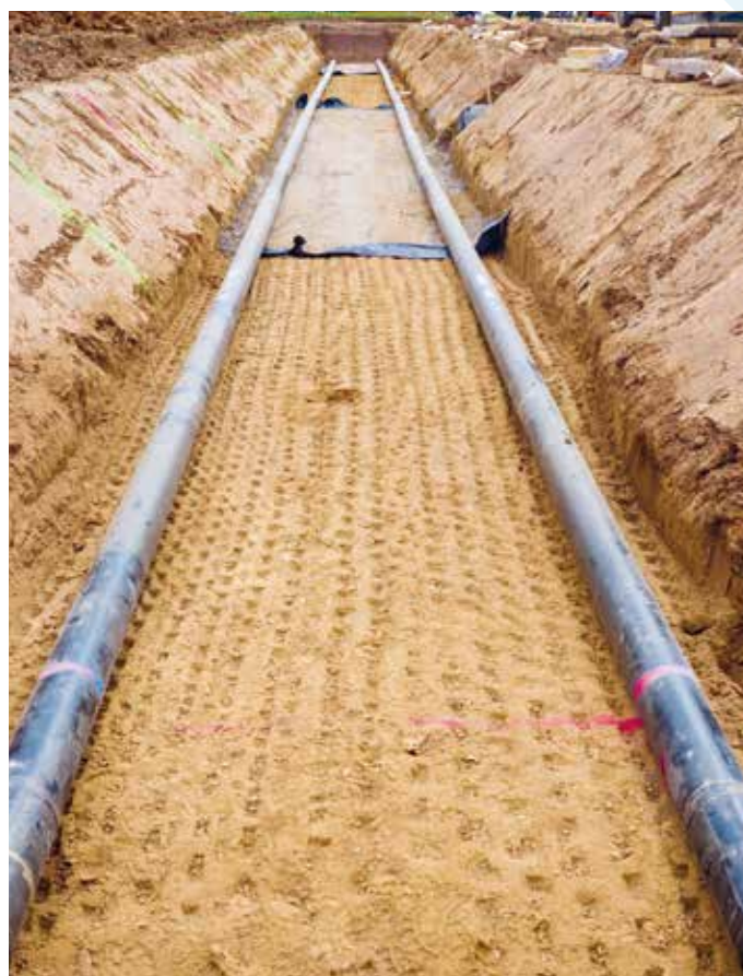
Durch beheizte Rohre wird eine mögliche Wechselwirkung zwischen Erdkabeln und der Landwirtschaft simuliert.
