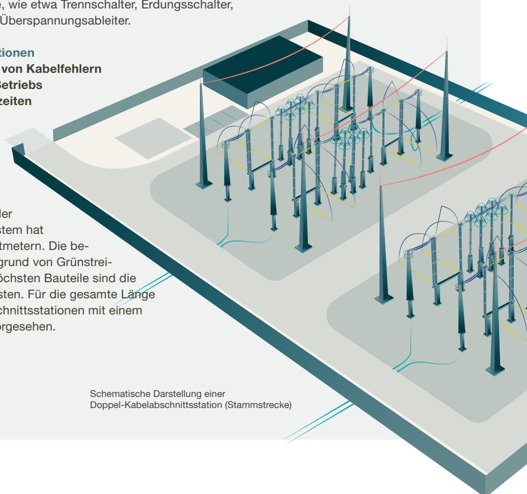
Schematische Darstellung einer Doppel-Kabelabschnittsstation (Stammstrecke)
