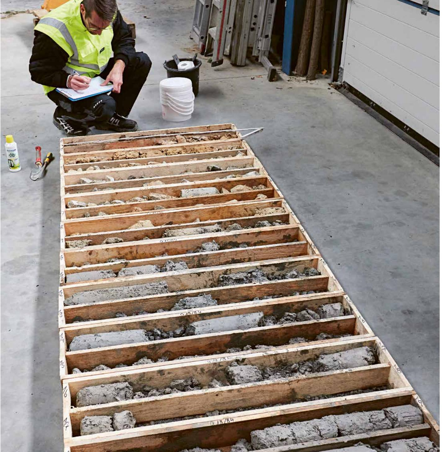
Bei Baugrunduntersuchungen wurden Böden entlang des SuedLink-Verlaufs genauestens analysiert, um den Bau von SuedLink den lokalen Gegebenheiten anzupassen.
