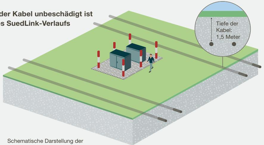
Schematische Darstellung der oberirdischen Linkboxen mit Schutzpollern
